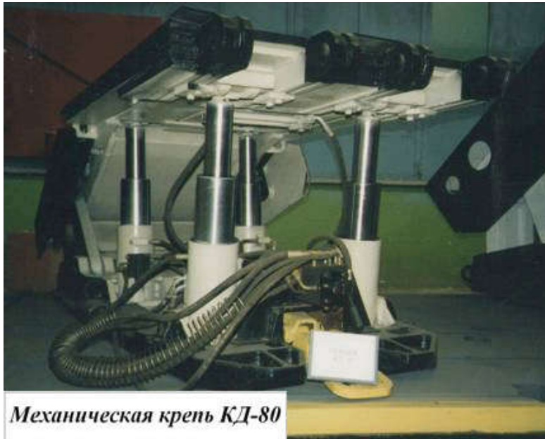
Механизированные крепи, производства АО «ФАЗС» входящие в лавный комплекс
